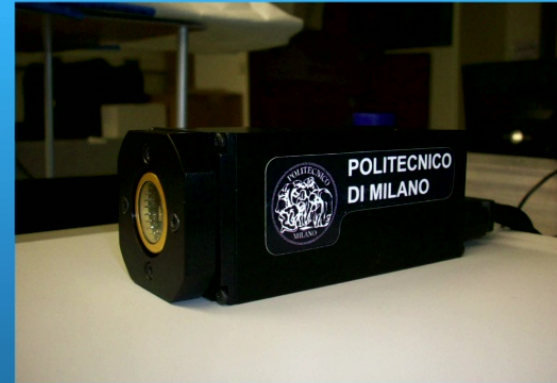
8-pixel linear array
