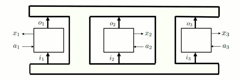
$$i_1 = \bar{o}_2 o_3, i_2 = \bar{o}_3 o_1, i_3 = \bar{o}_1 o_2$$
