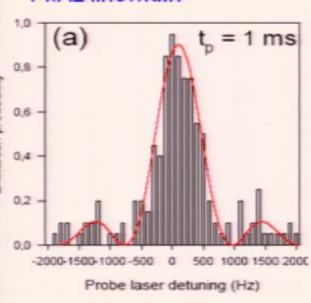
"standard operation" τ(pulse)=30 ms 30 Hz linewidth
